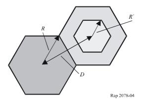
Соотношение между размером кластера, требуемым отношением C/I для получения  $CIR_{cov}$  и величиной охвата в случае конфигурации сотовой сети, обеспечивающей повсеместный охват для сети с полной нагрузкой и постоянными значениями уровня модуляции и скорости кодирования, может быть приблизительно описано по формуле [4]:
