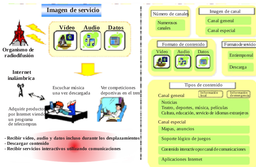
FIGURA 9.57 Imagen de servicio del sistema de radiodifusión de multimedia ISDB-T
