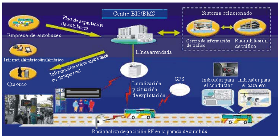
FIGURA 72 Arquitectura del sistema BMS
