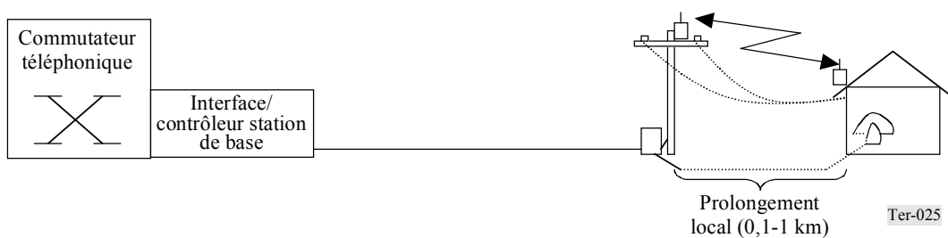
Système à boucle locale hertzienne fonctionnant en mode téléphonique sans fil
