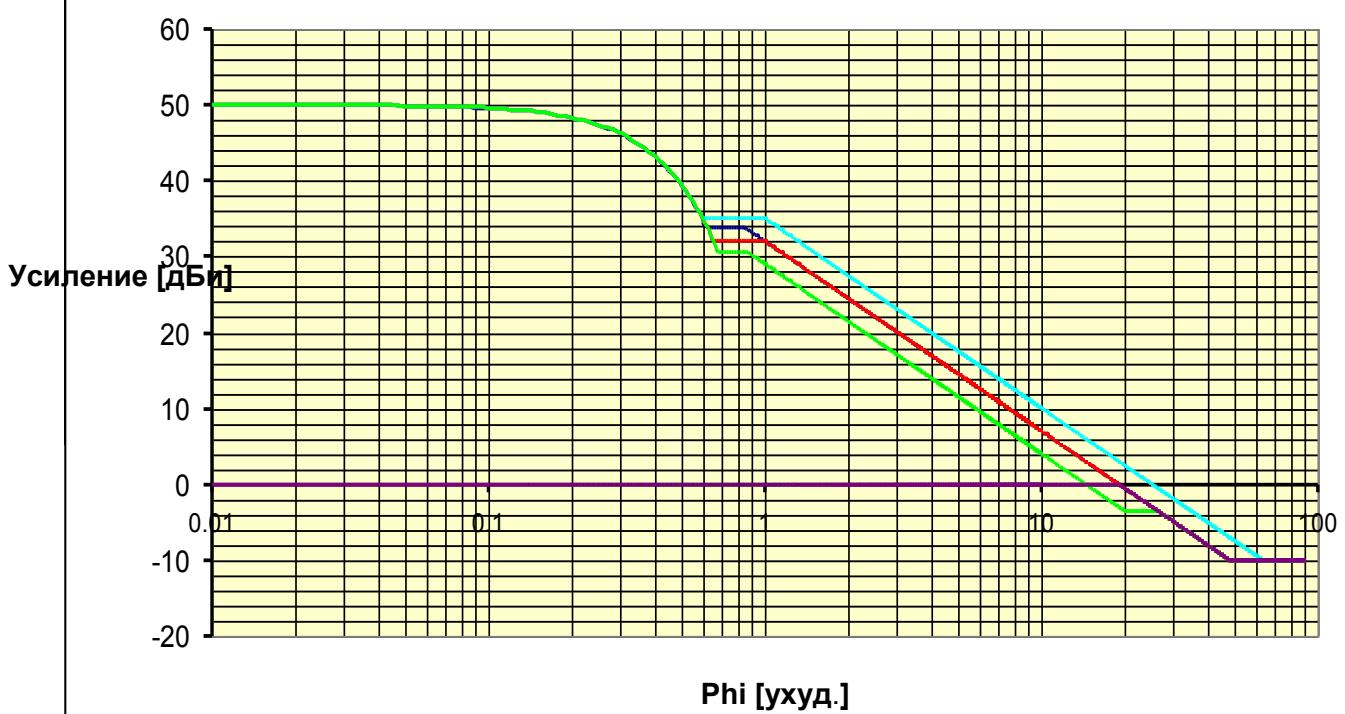
На следующей диаграмме показано, как изменяется главный лепесток с изменением диаметра антенны, наблюдается уменьшение помех приблизительно на 5 дБ, создаваемых спутнику, расположенному с разносом в 1 градус, при увеличении диаметра антенны от 1,2 до 13 метров.
