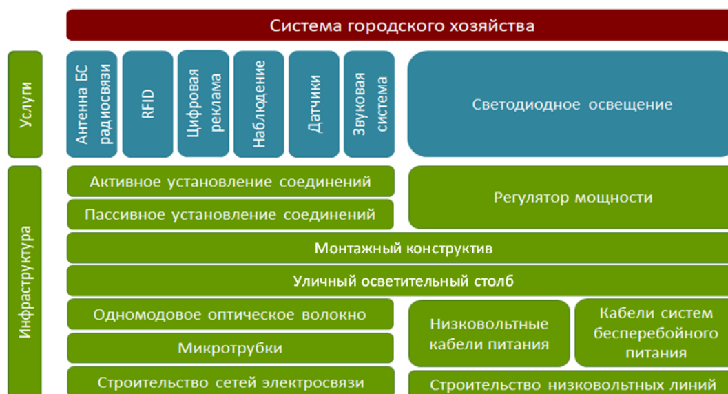
Рисунок 4: Компоненты "умных" уличных осветительных столбов
