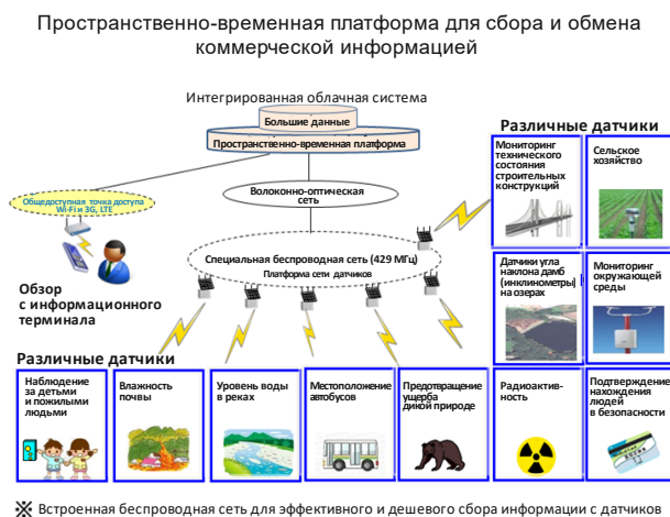
Рисунок 2: Платформа для сбора данных об окружающей среде и сеть IoT-датчиков города Сёдзири
