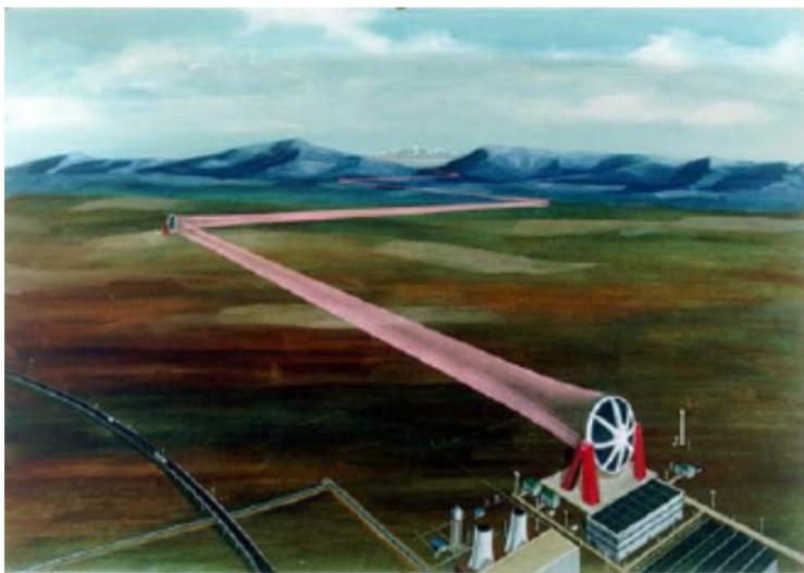
Рисунок 29. Эксперимент по передаче электроэнергии из пункта в пункт на расстояние в одну милю с 26-метровой параболической антенной и клистроном 2,388 ГГц мощностью 450 кВт в качестве передатчика и ретленной решеткой размером 3,4 × 7,2 м в качестве приемника
