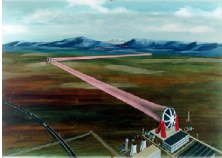
Figure 28: Représentation d'un système WPT point à point
