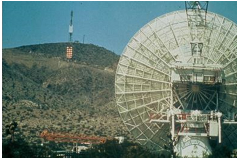
Figure 29: Expérience d'acheminement d'énergie sur 1,6 km par un système MPT point à point. On a employé une antenne parabolique de 26 m et un émetteur Klystron de 450 kW fonctionnant dans la bande des 2,388 GHz, ainsi qu'un réseau d'antennes redresseuses de 3,4 \times 7,2 m comme récepteur
