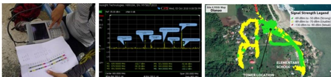
Barrido de espectro con un analizador de espectro portátil
