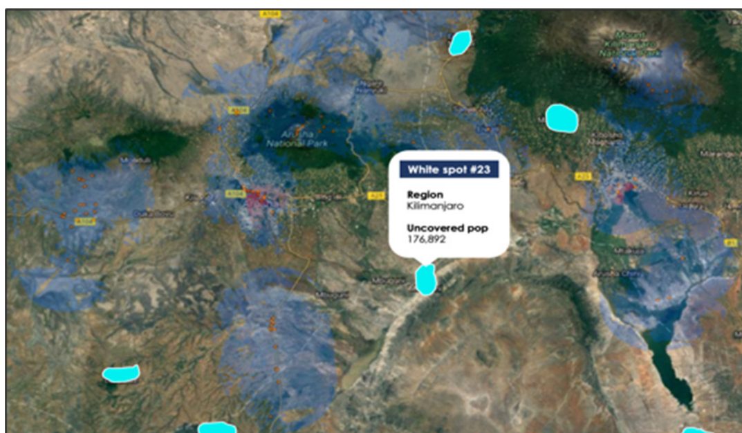
Figure A1.2. Algorithme de Masae Analytics avec données ouvertes granulaires sur la densité de population granulaire et informations sur la couverture visant à détecter les zones les plus prometteuses ("zones blanches") en vue de l'installation de nouvelles stations de base
