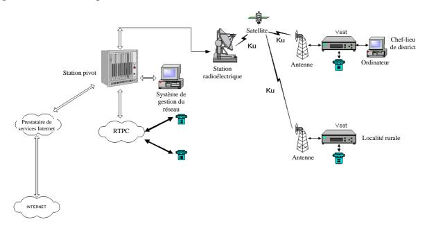
Les stations distantes se composent généralement de deux modules: l'unité extérieure (unité ODU) et l'unité intérieure (unité IDU), qui comprend l'unité VSAT, en dehors du sous-système d'alimentation électrique et du sous-système de protection.
