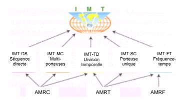
Figure 7 – Normes des interfaces radioélectriques des IMT-2000
