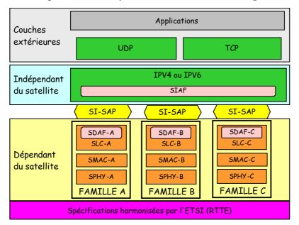
Figure 15 - Architecture du protocole d'un système à satellites mondial large bande
