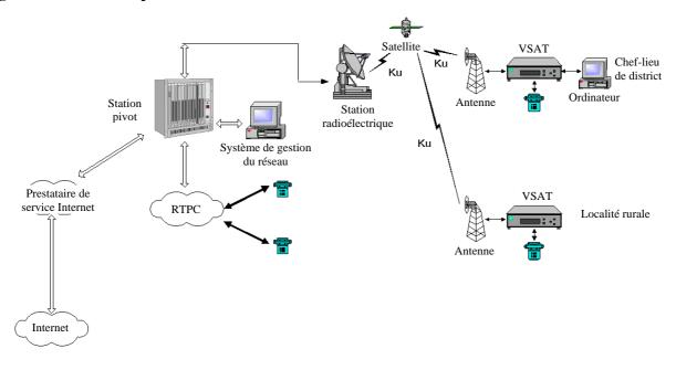
Les stations distantes comprennent généralement deux modules: l'unité extérieure et l'unité intérieure, qui inclut l'unité VSAT, en dehors du sous-système d'alimentation électrique et du sous-système de protection.
