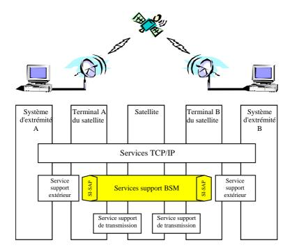
Figure 14 - Architecture d'un service par satellite large bande fonctionnant à l'échelle mondiale
