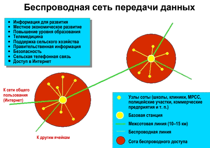
Рисунок 6 – Беспроводная сеть передачи данных
