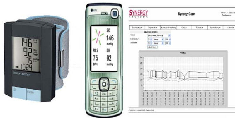
Figure 4: Telemedical, mobile blood-pressure-measuring system of the Heinz Nixdorf-Lehrstuhl für Medizinische Elektronik in cooperation with Sensor GmbH
