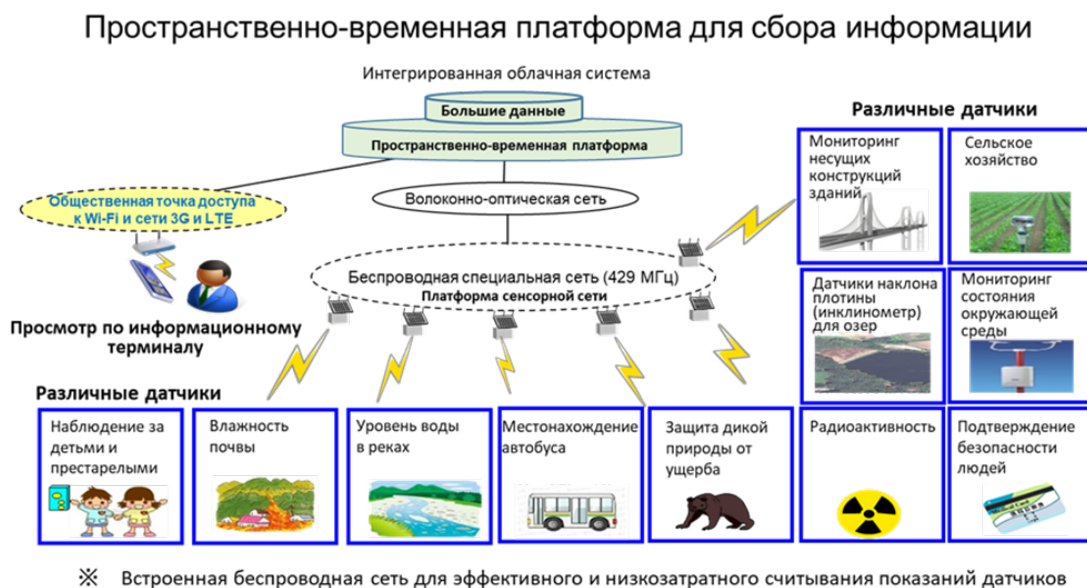
Рисунок 11: Платформа для сбора экологических данных и система датчиков в Сиодзире
