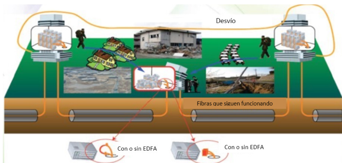
Figura 9: Reconexión de enlaces de fibra óptica
