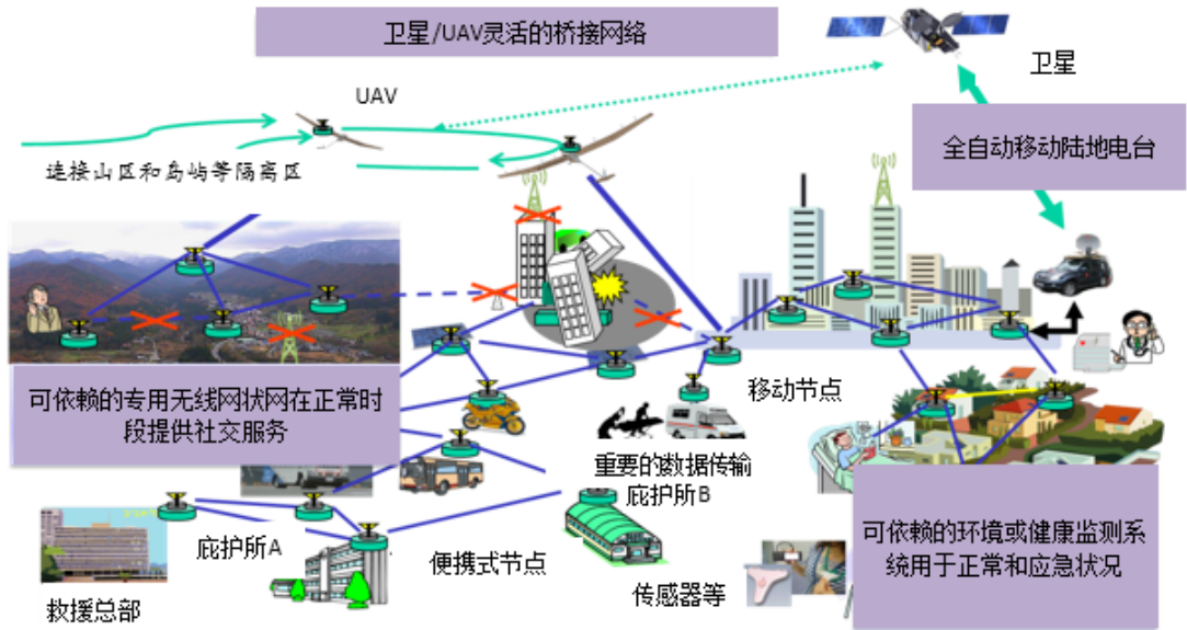
图6：本地无线网状网架构
