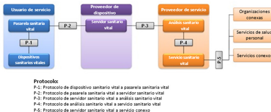
Figura 5: Modelo de referencia para servicios sanitarios vitales destinado a la gestión de la salud personal
