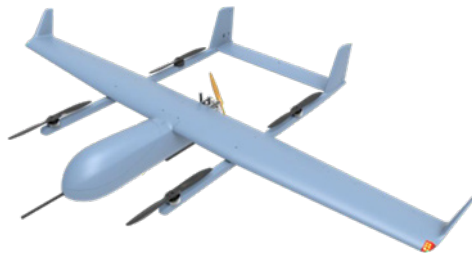
Рисунок 6: Среднеразмерный беспилотный летательный аппарат VTOL с неподвижным крылом
