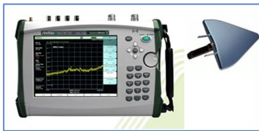
Рисунок 5: Анализатор спектра с направленной антенной
