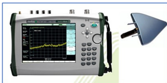
图5: 配有定向天线的频谱分析仪
