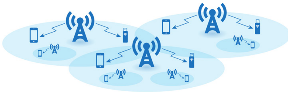
Рисунок 6: Неоднородная сеть LTE
