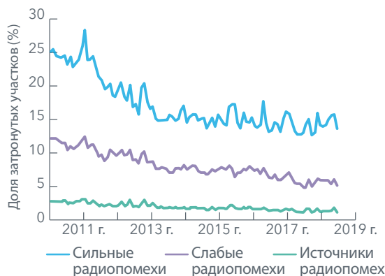
Рисунок 3. Изменение процентной доли участков измерения SMOS на поверхности Земли, затронутых радиопомехами, в период 2010-2018 годов
