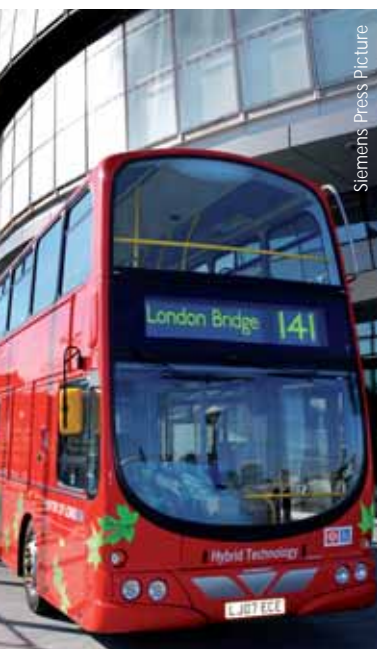
Londres: dans cet autobus hybride, l'électricité assure une partie de la propulsion ainsi que la gestion des alimentations
