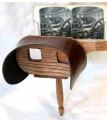
Un dispositif ancien illustre le principe des images stéréoscopiques en 3D
