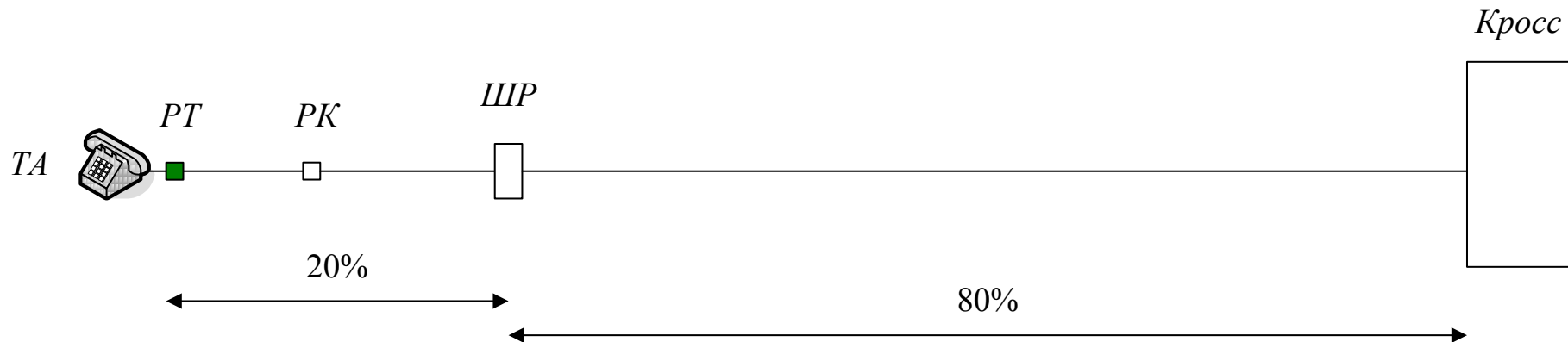
а) Модель эксплуатируемой сети доступа
