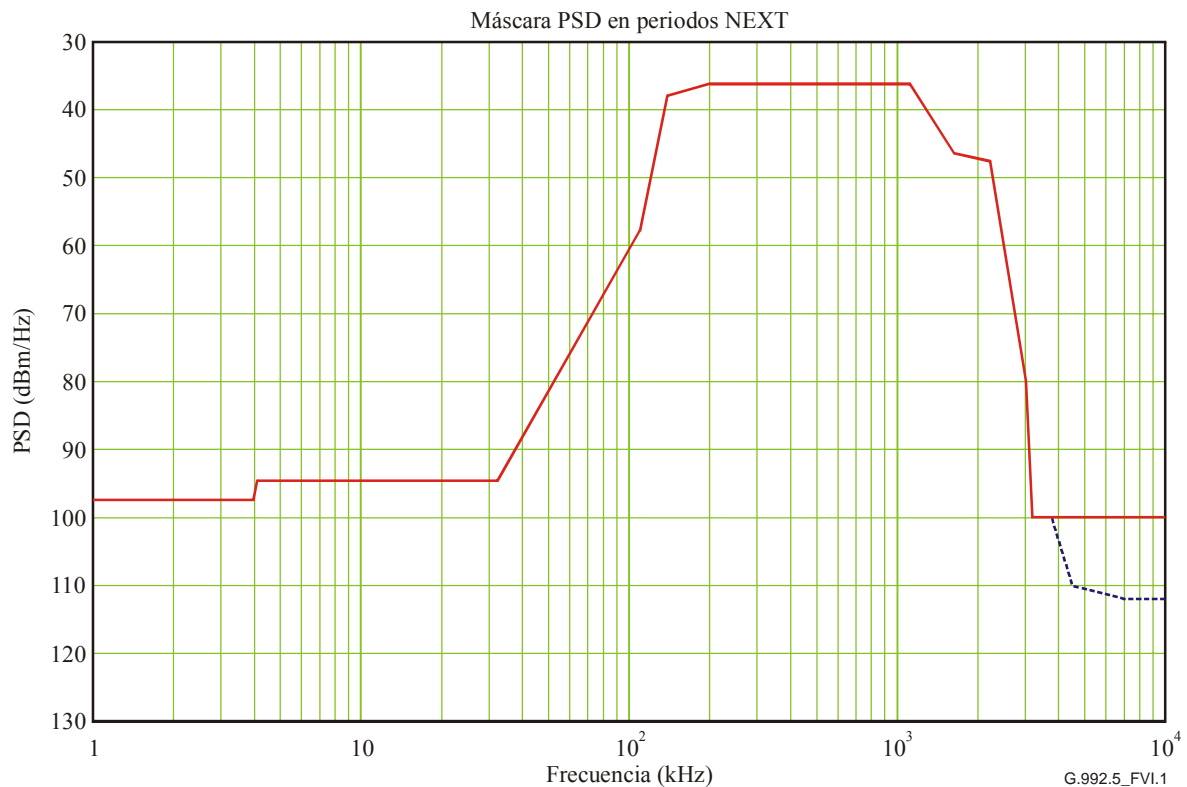
Figura VI.1/G.992.5 – Máscara de PSD superpuesta y conformada en sentido descendente para su utilización en periodos NEXT del reloj TTR
