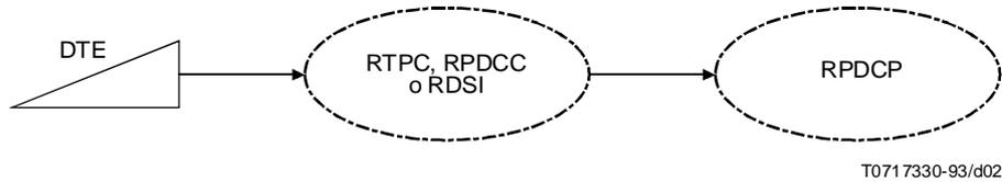
NOTA – En el caso de la RDSI, se accede a la RDSI por medio de funciones de TA que pueden estar aplicadas en equipos separados (caso de DTE y TA) o en un mismo equipo (caso de TE1) como funciones del DTE.
