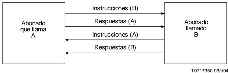
NOTA – Para la marcación de entrada por el DTE, el DTE es el abonado que llama A; para la marcación de salida por la RPDCP, el DCE es el abonado que llama A.
