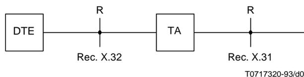
NOTA – Las funcionalidades del DTE y del TA pueden ser implementadas en el mismo terminal TE1. En tal caso, esta Recomendación abarca la operación en las capas 2 y 3, en el canal B, mientras que los procedimientos en el punto de referencia S se describen en la Recomendación X.31.
