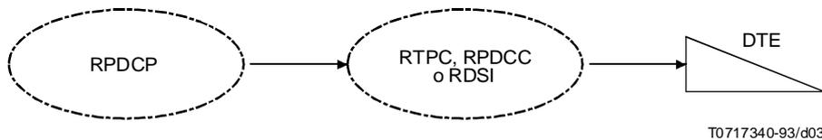
NOTA – En el caso de la RDSI, se accede a la RDSI por medio de funciones de TA que pueden estar aplicadas en equipos separados (caso de DTE y TA) o en un mismo equipo (caso de TE1) como funciones del DTE.
