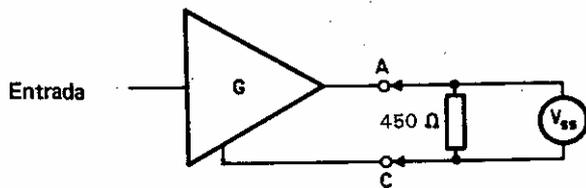
$V_{ss}$  = diferencia de tensiones entre los estados permanentes de la señal
