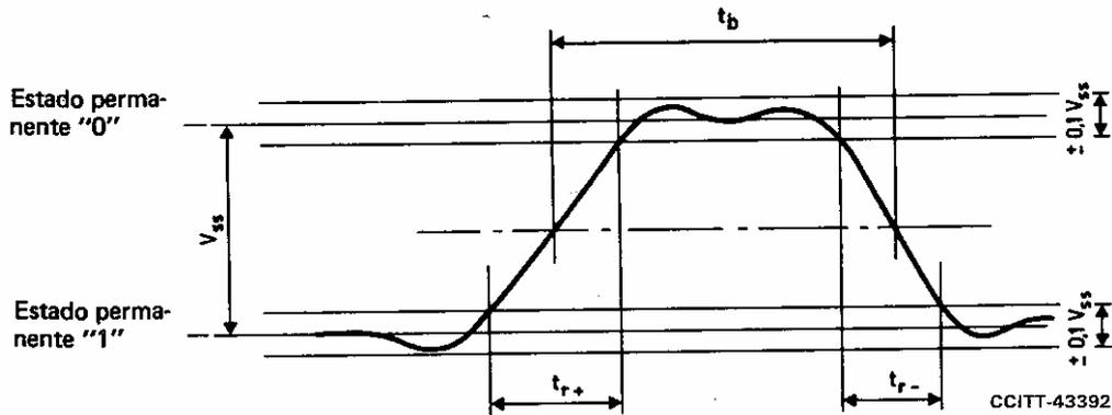
$t_b$  = duración nominal del elemento de la señal de prueba
