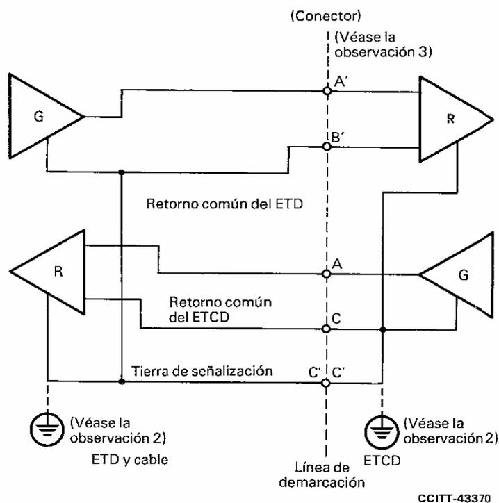
*Observación 1* – Los puntos de enlace de referencia cero voltios C' se pueden interconectar a través del conductor de tierra de señalización.
