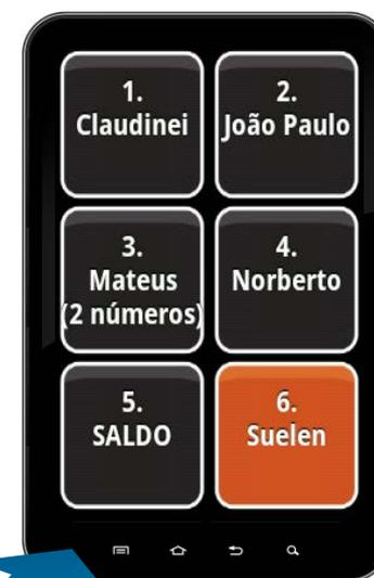
Com a tela dividida em 6 áreas, a navegação pelas aplicações ocorre de forma simples deslizando ou tocando o dedo na tela *touchscreen* do *smartphone*, uma voz sintetizada informa a função correspondente àquela área e, com um duplo-toque, acessa à função desejada. Todas as telas se apresentam da mesma forma, proporcionando que os usuários aprendam uma única vez para todas as aplicações.
