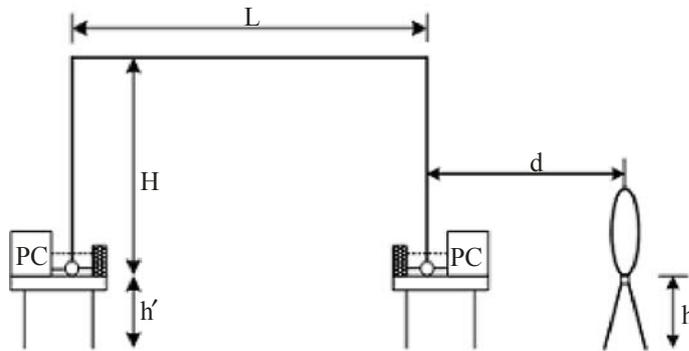
测量装置(PLT装置侧面)
