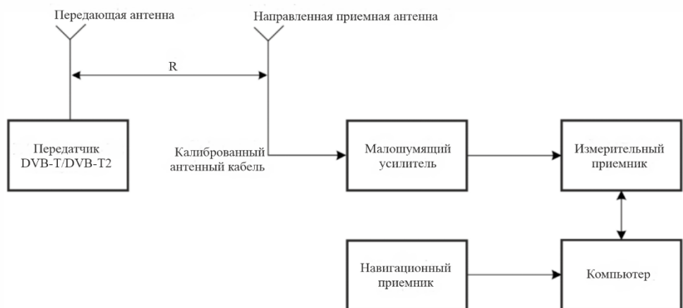
РИСУНОК 26 Схема подключения оборудования
