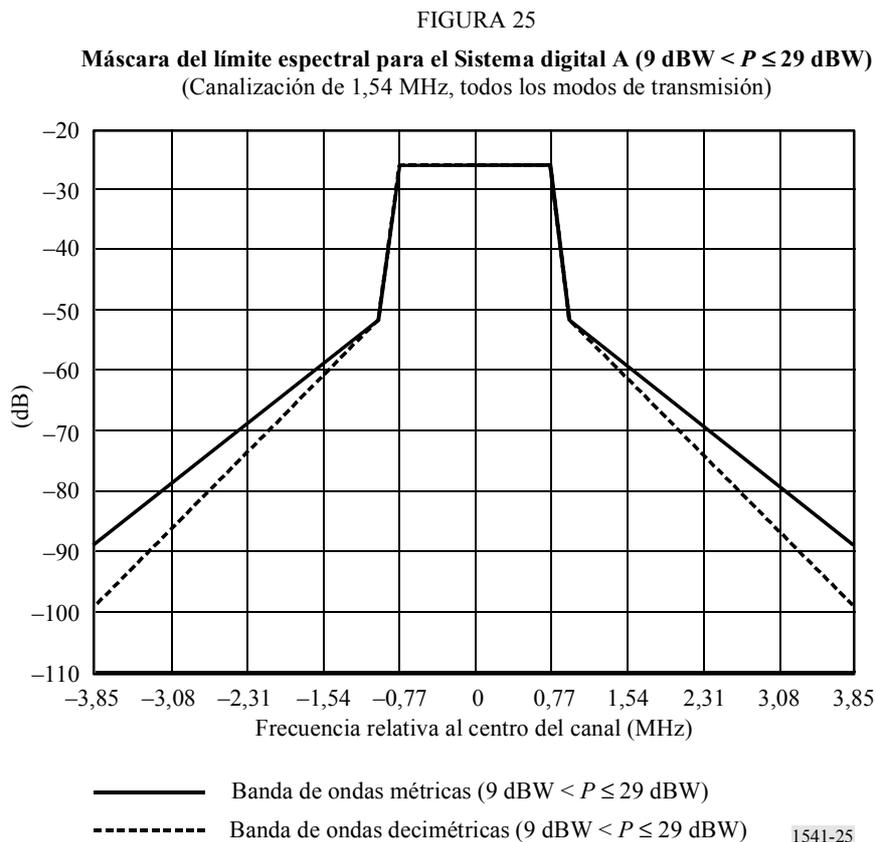
El Cuadro 19 proporciona los valores de punto extremo que deben utilizarse conjuntamente con el Cuadro 18 y la Fig. 25, y que es aplicable a una gama de potencias de salida del transmisor para el Sistema digital A.
