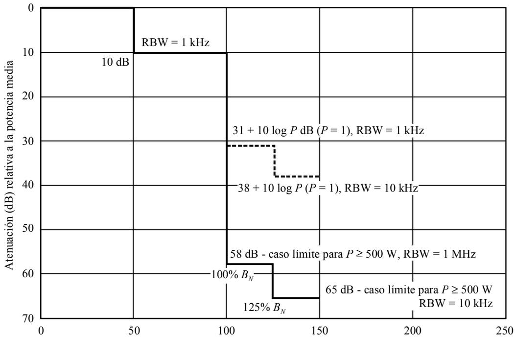
Separación en frecuencia desde el centro de la emisión, expresado como porcentaje de la anchura de banda necesaria  $B_N$  a la que se suma el valor de separación dado en la Recomendación UIT-R SM.1539 a fin de obtener la separación de frecuencia real.
