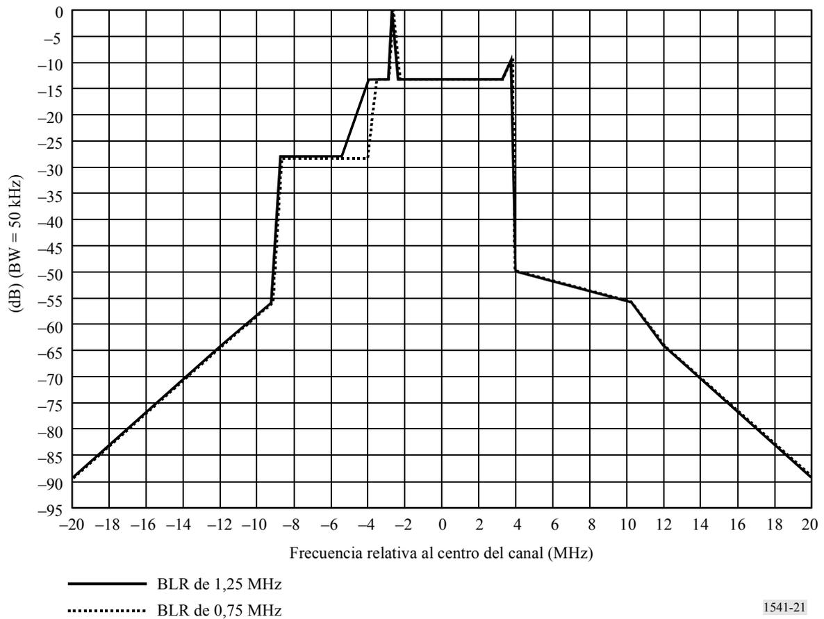
El Cuadro 11 proporciona los puntos de discontinuidad correspondientes al gráfico de la Fig. 21 para la televisión analógica de 8 MHz, modulación positiva y BLR de 0,75 MHz y 1,25 MHz.
