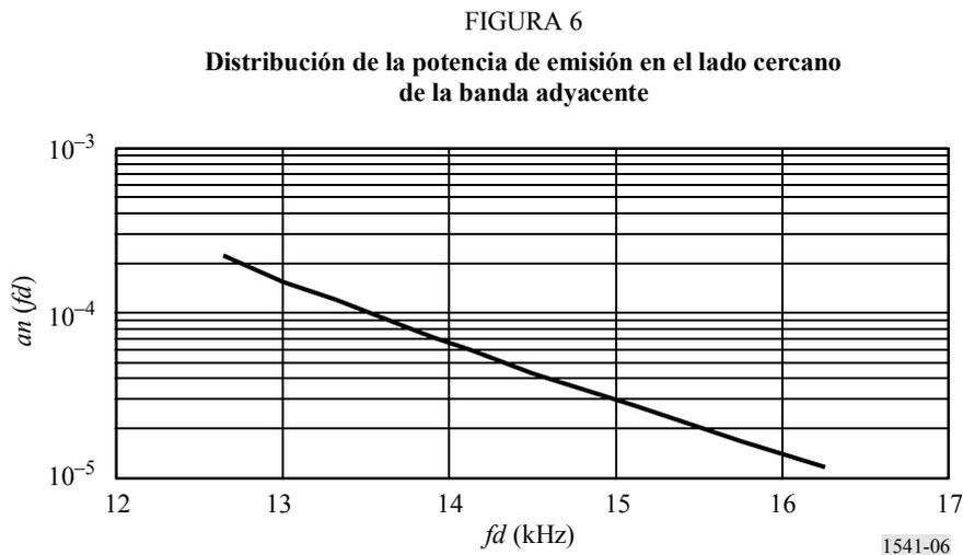
La relación entre la potencia total en la banda adyacente y la potencia total de la emisión se calcula sumando la potencia en la anchura de banda de la banda adyacente que se muestra en la Fig. 6 mediante la siguiente ecuación:
