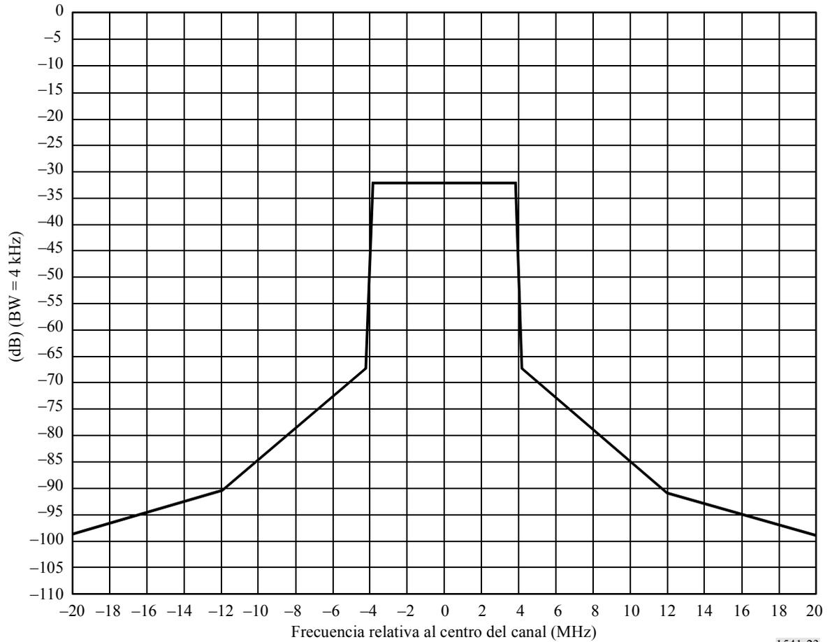
El Cuadro 15 proporciona los puntos de discontinuidad correspondientes a la Fig. 23 para los Sistemas DVB-T de 8 MHz.
