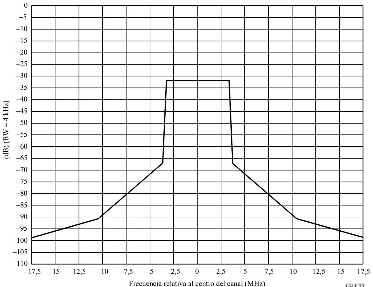
El Cuadro 13 proporciona los puntos de discontinuidad correspondientes a la Fig. 22 para los Sistemas DVB-T de 7 MHz.
