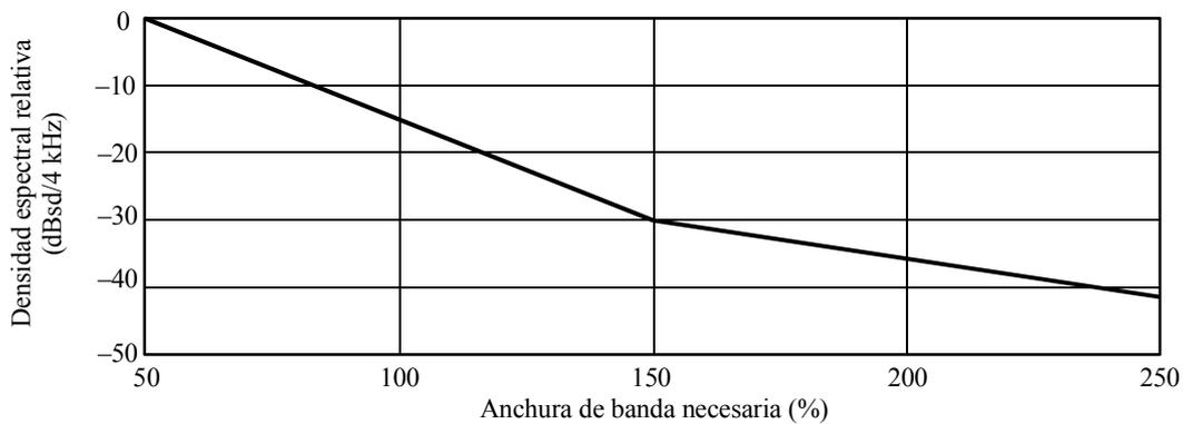
Nota 1 – La máscara de emisión se extiende en general hasta el 250% de la anchura de banda necesaria. Sin embargo, el borde externo del dominio fuera de banda de los sistemas de banda ancha y de banda estrecha se modifica tal como se indica en la Recomendación UIT-R SM.1539.
