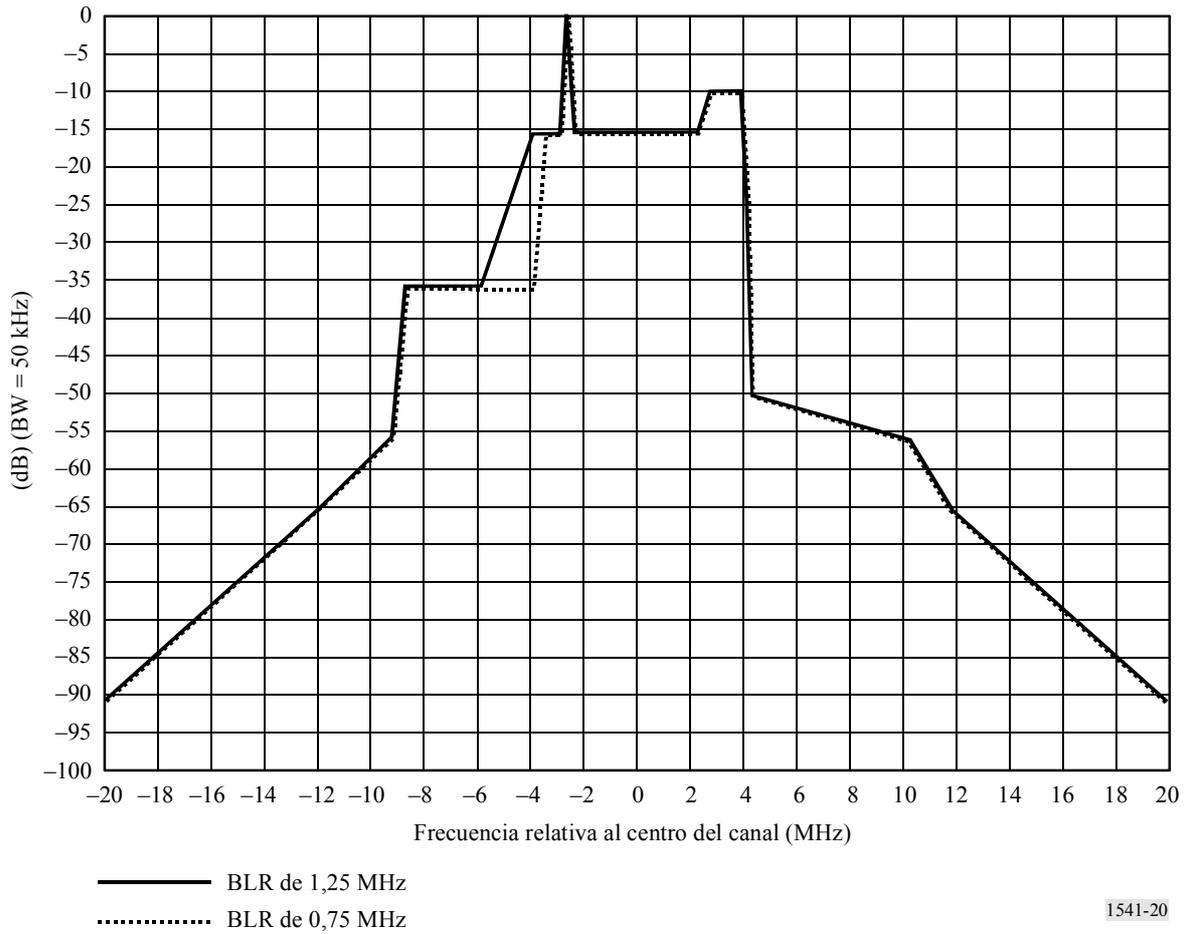
El Cuadro 9 proporciona los puntos de discontinuidad correspondientes al gráfico de la Fig. 20 para televisión analógica de 8 MHz, modulación negativa y BLR de 0,75 MHz y 1,25 MHz.
