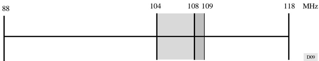
La partie hachurée représente la gamme de fréquences dans laquelle le récepteur de type Montréal peut présenter plus de probabilités de brouillage de type B1 que le récepteur GE84.
