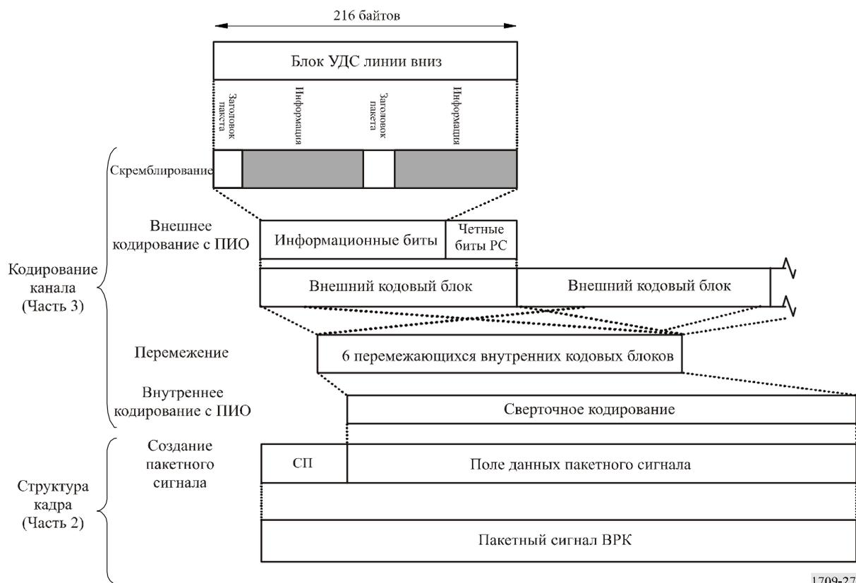
Данные на линии вниз передаются большими пакетными сигналами с ВРК, причем каждый пакетный сигнал содержит шесть перемежающихся кодировых блоков. После декодирования с ПИО происходит обратное перемежение.
