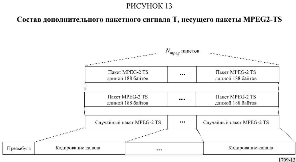
СТОК может установить число пакетов во временном интервале T на основании поля длительности временного интервала КТВИ после вычитания длительности времени других полей. Передача пакетных сигналов T MPEG2-TS необязательна. СТОК поставит в известность СЦУ о том, что он поддерживает этот механизм в пакетном сигнале КОС.
