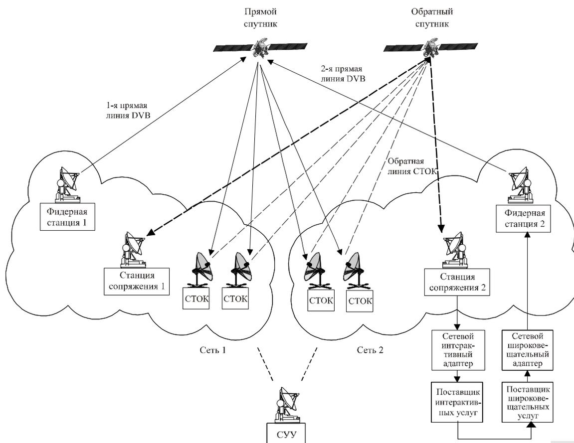
По прямому каналу переносится сигнализация от СЦУ и трафик пользователя до СТОК. Сигнализация от СЦУ до СТОК, необходимая для эксплуатации системы с обратным каналом, ниже называется "сигнализацией прямого канала". Трафик пользователя и сигнализация прямого канала могут переноситься различными сигналами прямого канала. Возможно несколько конфигураций СТОК в зависимости от числа приемников прямого канала, имеющих на СТОК.
