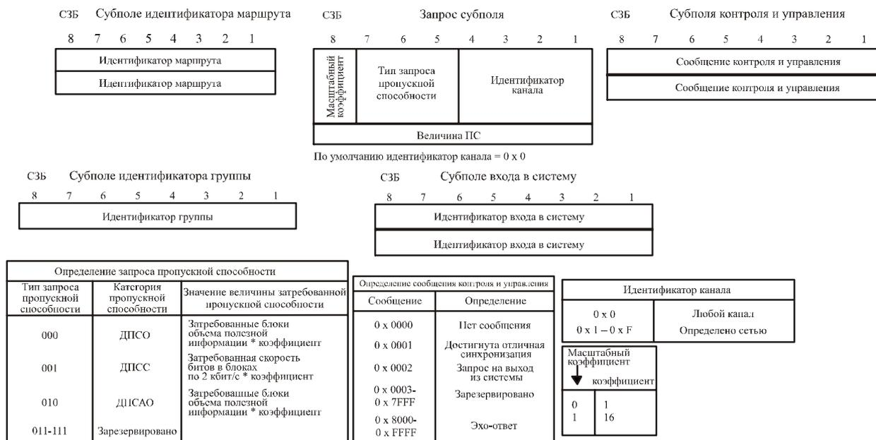
Размер полезной информации = 53 или 188 байтов в соответствии с режимом инкапсуляции, определенным при входе в систему.
