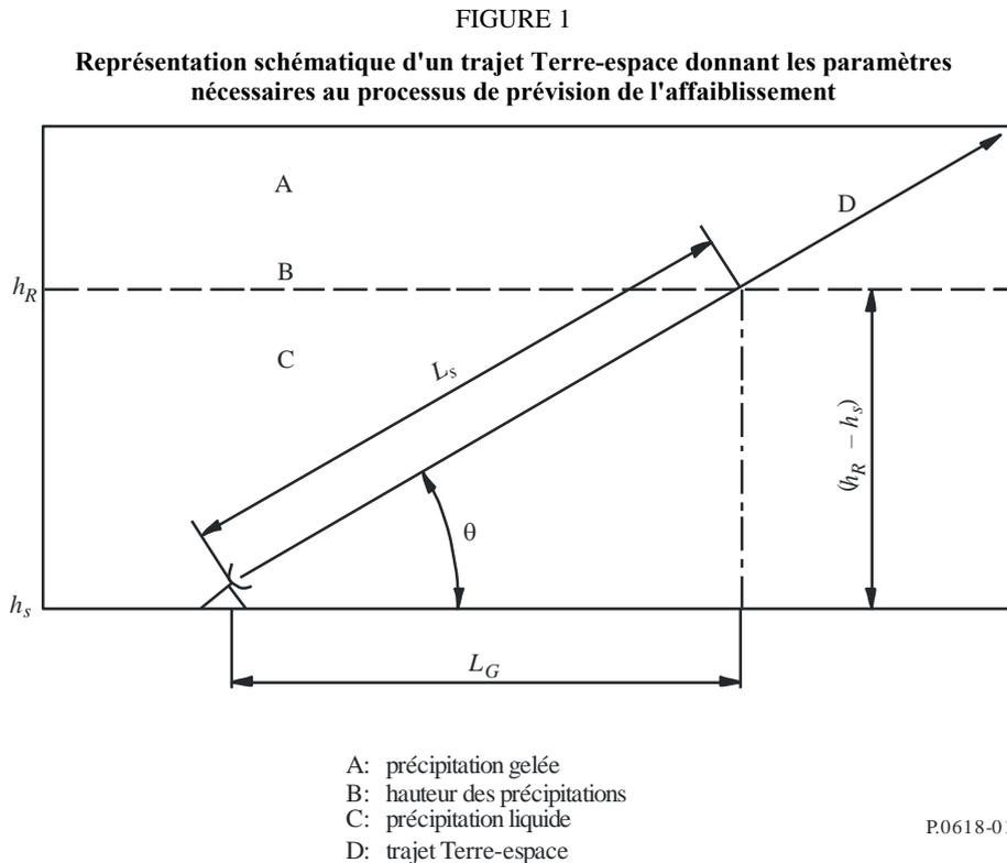
*Etape 1:* Déterminer la hauteur de pluie,  $h_R$ , donnée dans la Recommandation UIT-R P.839:
