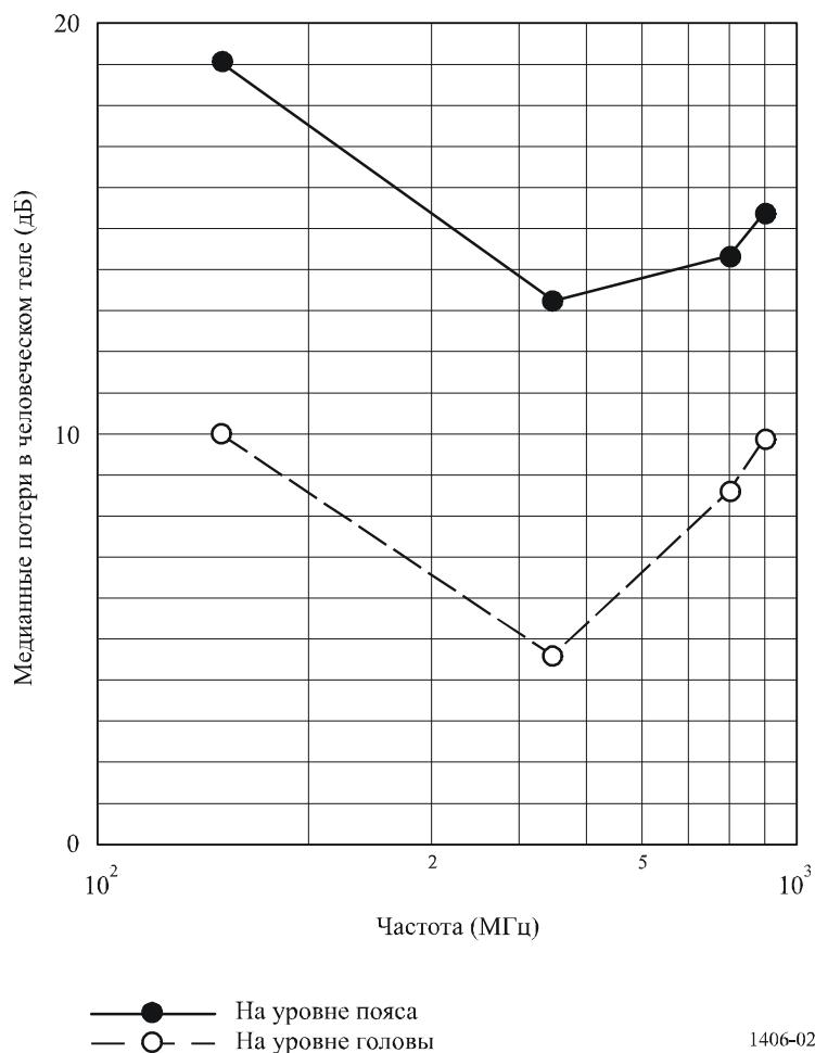
При рассмотрении приемников пейджинговой связи нельзя говорить лишь о "потере в человеческом теле", потому что антenna приемника встроена в блок. По этой причине чувствительность приемника пейджинговой связи, в основном, определяется в терминах напряженности поля (как правило, в мкВт/м). Однако полезно знать какое усиление обеспечивает типовая встроенная антenna, если пейджер носится на боку. В таблице 2 показаны значения для конкретного пейджа на трех различных частотах.
