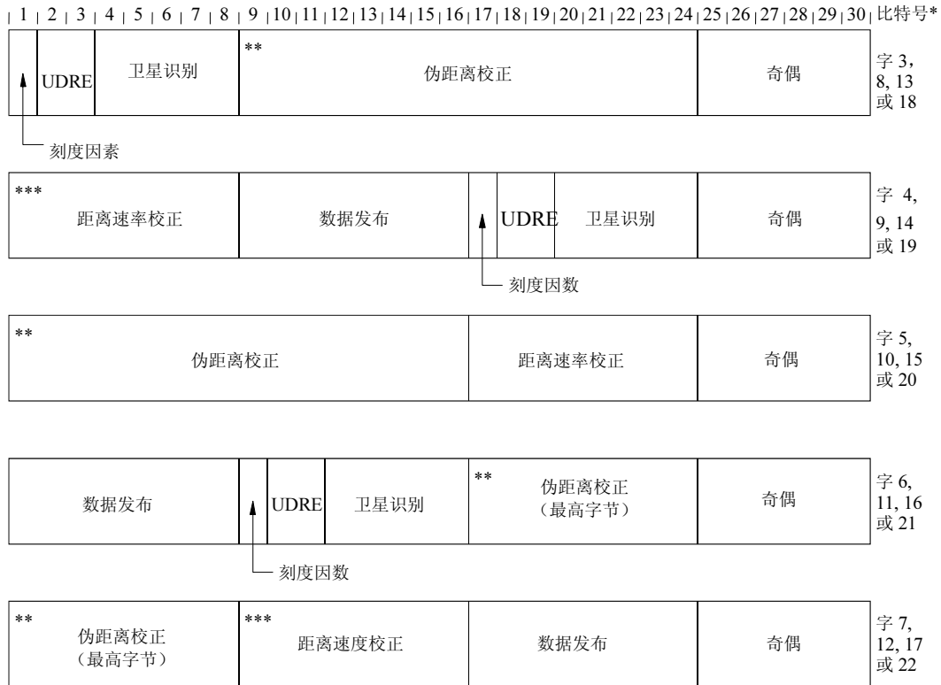
图 2 类型 1 和类型 9 的消息格式 差分 GPS 校正
