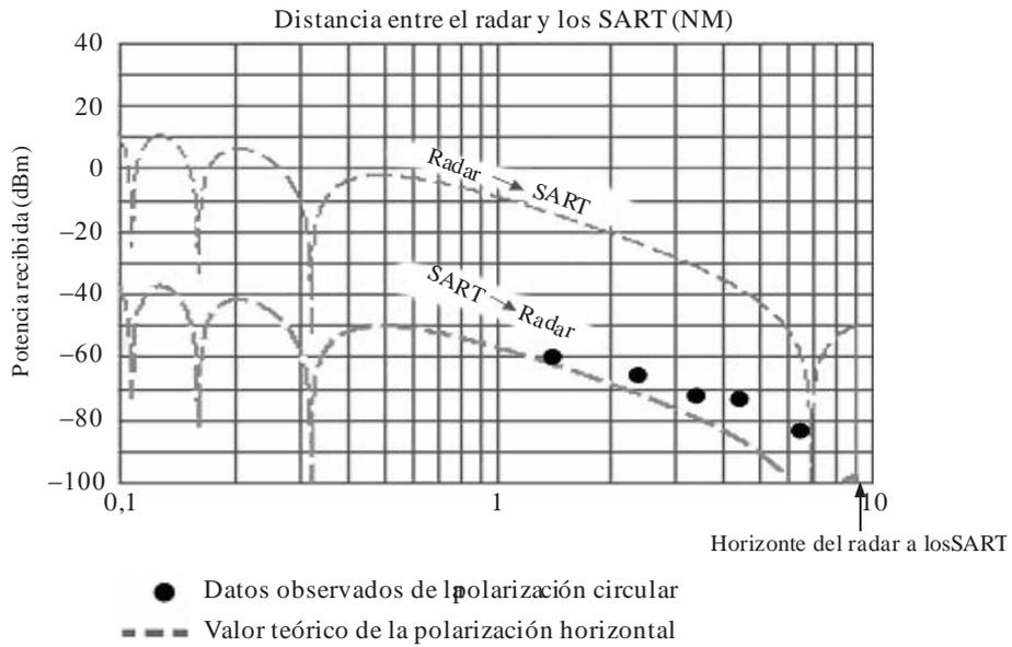
Radar: potencia de cresta: 25 kW altura de lanatena: 9,5 m
