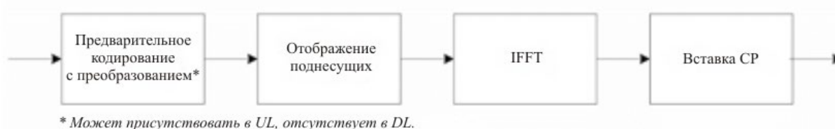
Блок-схема передатчика CP-OFDM с опциональным DFT-расширением
