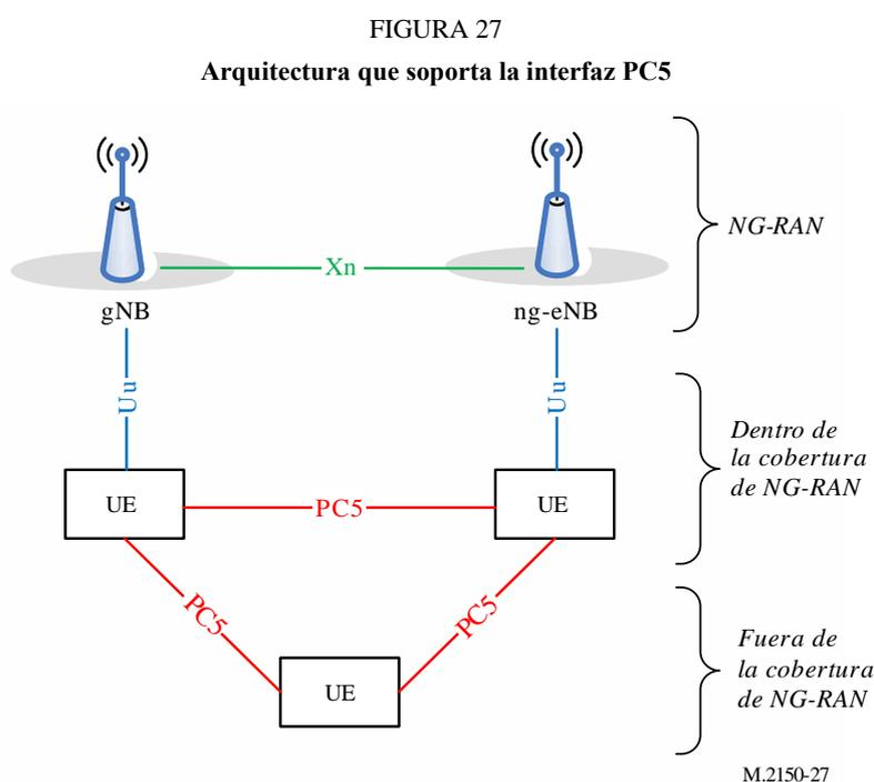
La comunicación de enlace lateral NR puede soportar tres tipos de modos de transmisión (en el estrato de acceso):
