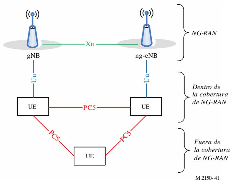
La comunicación de enlace lateral NR puede soportar tres tipos de modos de transmisión (en el estrato de acceso):
