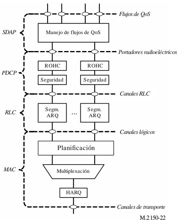
Al igual que en la LTE, los portadores radioeléctricos se clasifican en dos grupos: DRB para datos del UP y SRB para datos del CP.
