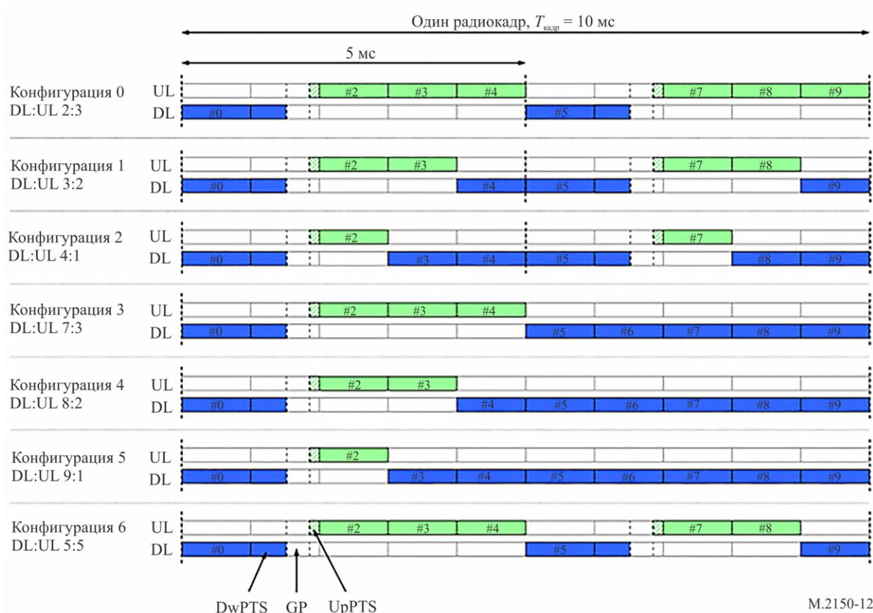
При передаче по прямым соединениям используется структура кадра, аналогичная той, которая определена для линий вверх и вниз, когда оборудование пользователя находится в зоне покрытия сети. Однако такая передача ограничена подбором ресурсов линии вверх во временной и частотной областях.
