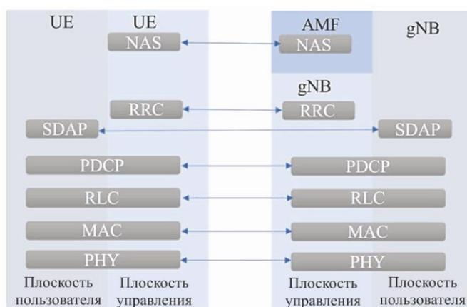
1. Физический уровень отвечает за кодирование (декодирование), модуляцию (демодуляцию), адаптацию скорости, обработку сигналов от нескольких антенн и генерирование соответствующего сигнала.
