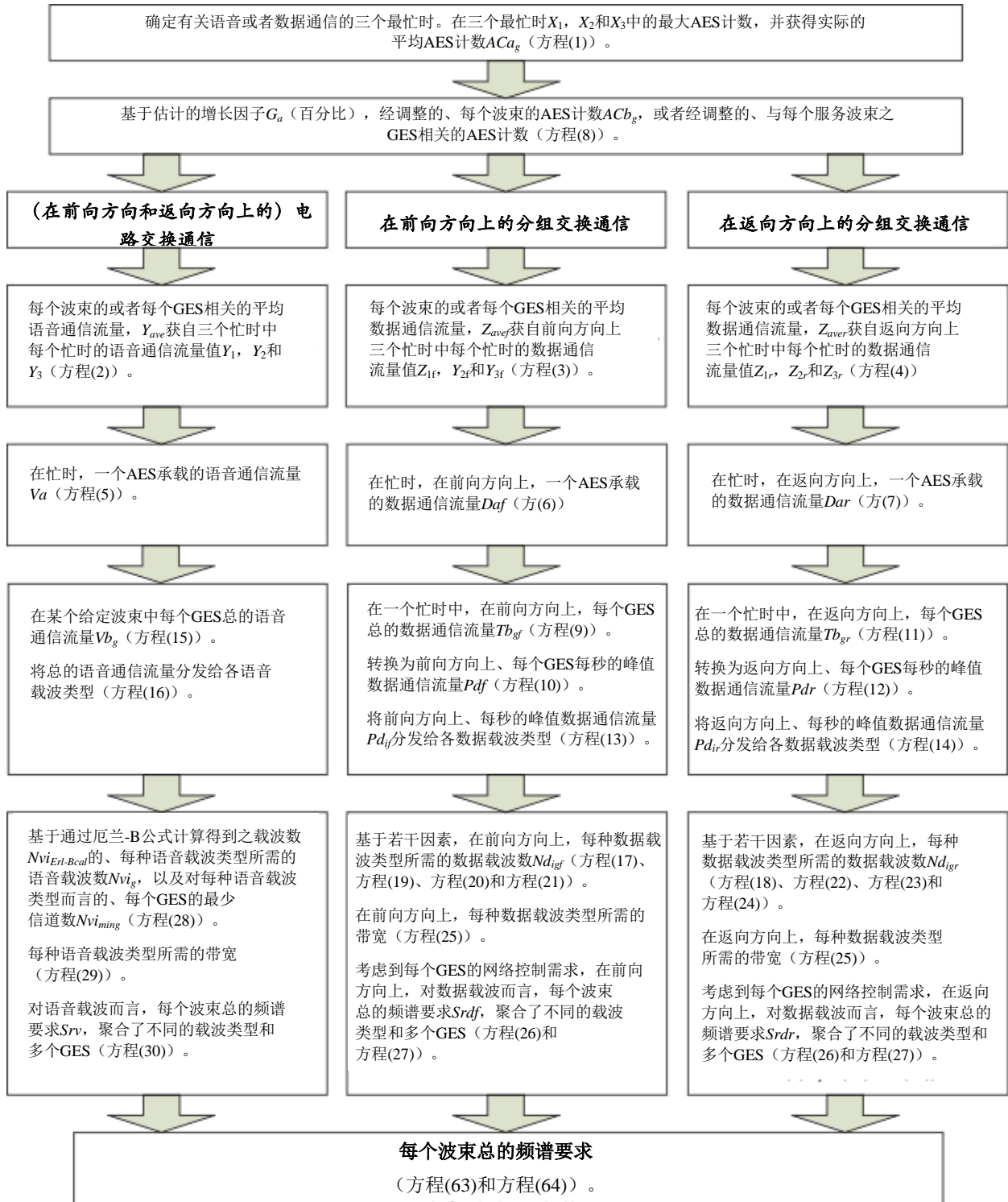
图1 描述计算AMS(R)S频谱要求之通用方法的流程图
