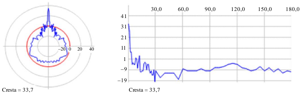
Diagrama de radiación de un Radar-C obtenido de mediciones (Rec. UIT-R M.1464)
