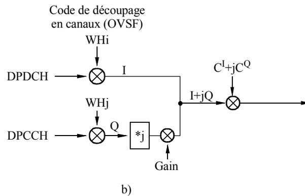
La longueur du code d'embrouillage est égale à une seule trame (38400 éléments). Une option pourvue d'un code bref (256) est en cours d'évaluation en vue d'une possible utilisation avec une technique de réduction des brouillages du type MMSE. Les séquences d'embrouillage sont les mêmes que celles définies dans la spécification TS25.213 (élaboré par le 3GPP).
