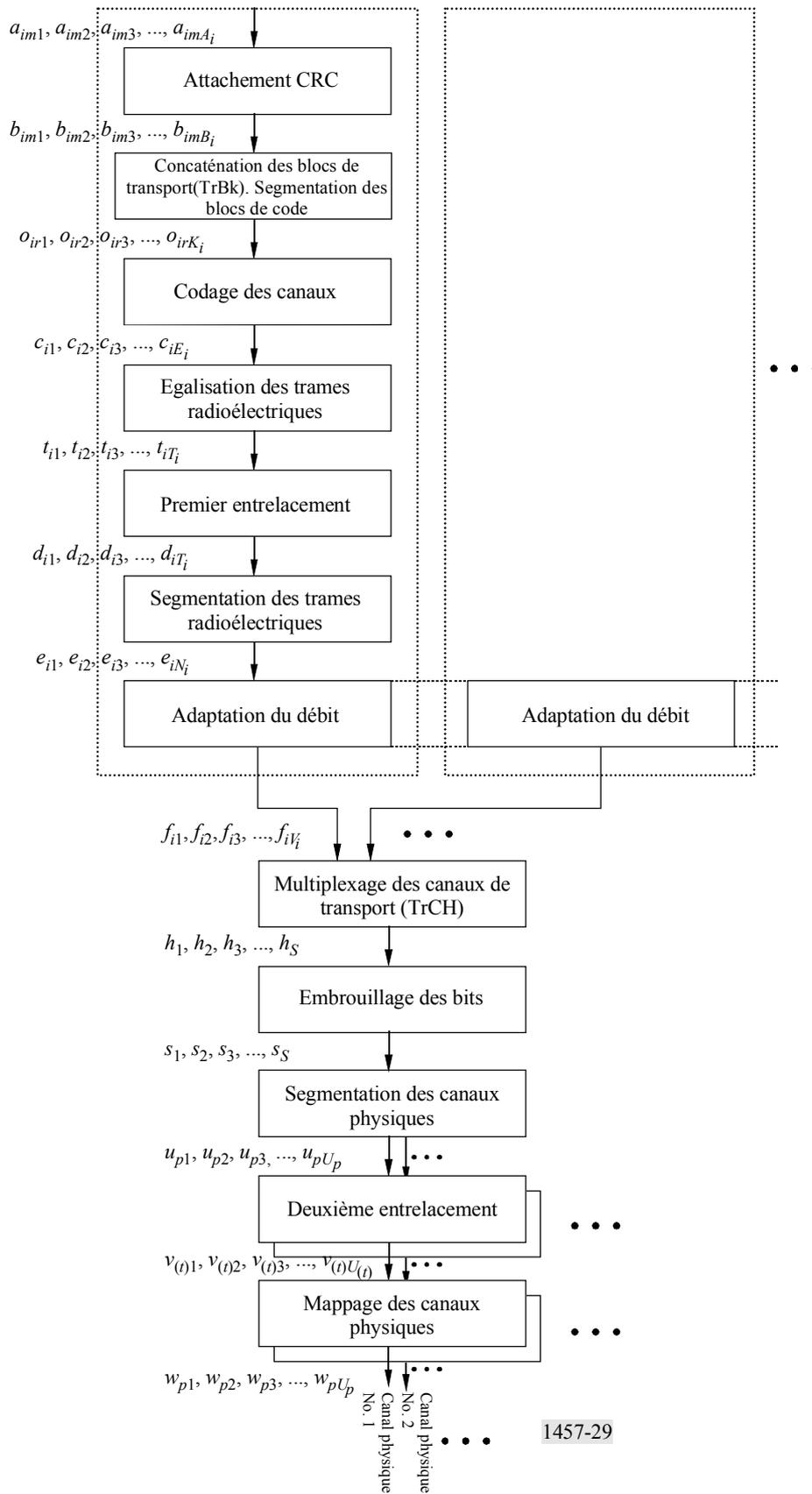
La segmentation des trames radioélectriques effectue le remplissage des bits. L'adaptation du débit adapte les éventuelles différences restantes du débit binaire de telle sorte que le nombre de bits sortants corresponde aux débits disponibles des canaux physiques. On utilise à cette fin le codage par répétition et/ou la discontinuité (puncturing).
