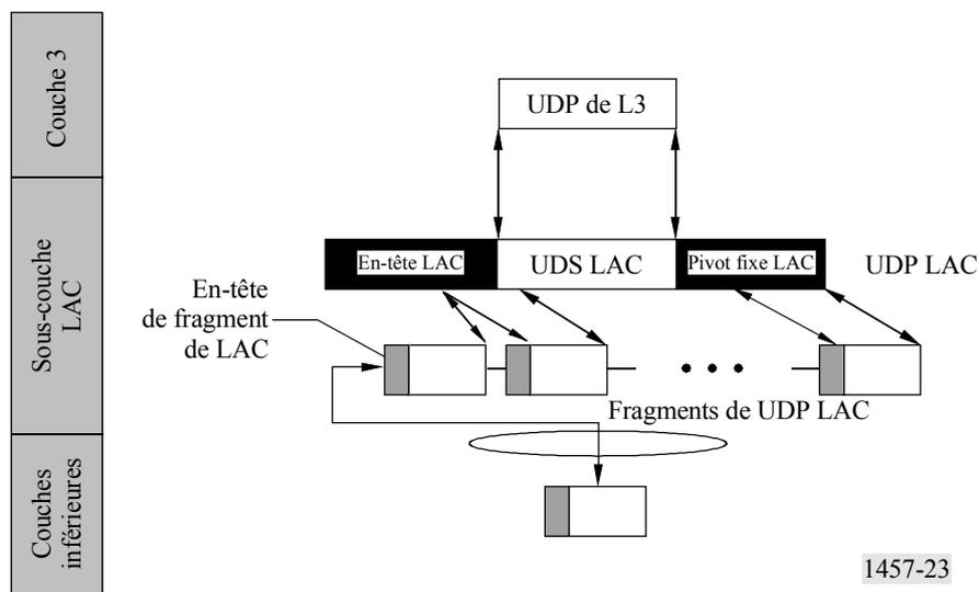
Dans le plan données, la couche 3 et la sous-couche LAC envoient et reçoivent des informations de signalisation sur les *canaux logiques*; elles peuvent donc ignorer les caractéristiques radioélectriques des canaux physiques. Le système décrit dans ce paragraphe utilise les types suivants de canal logique pour acheminer l'information de signalisation:
