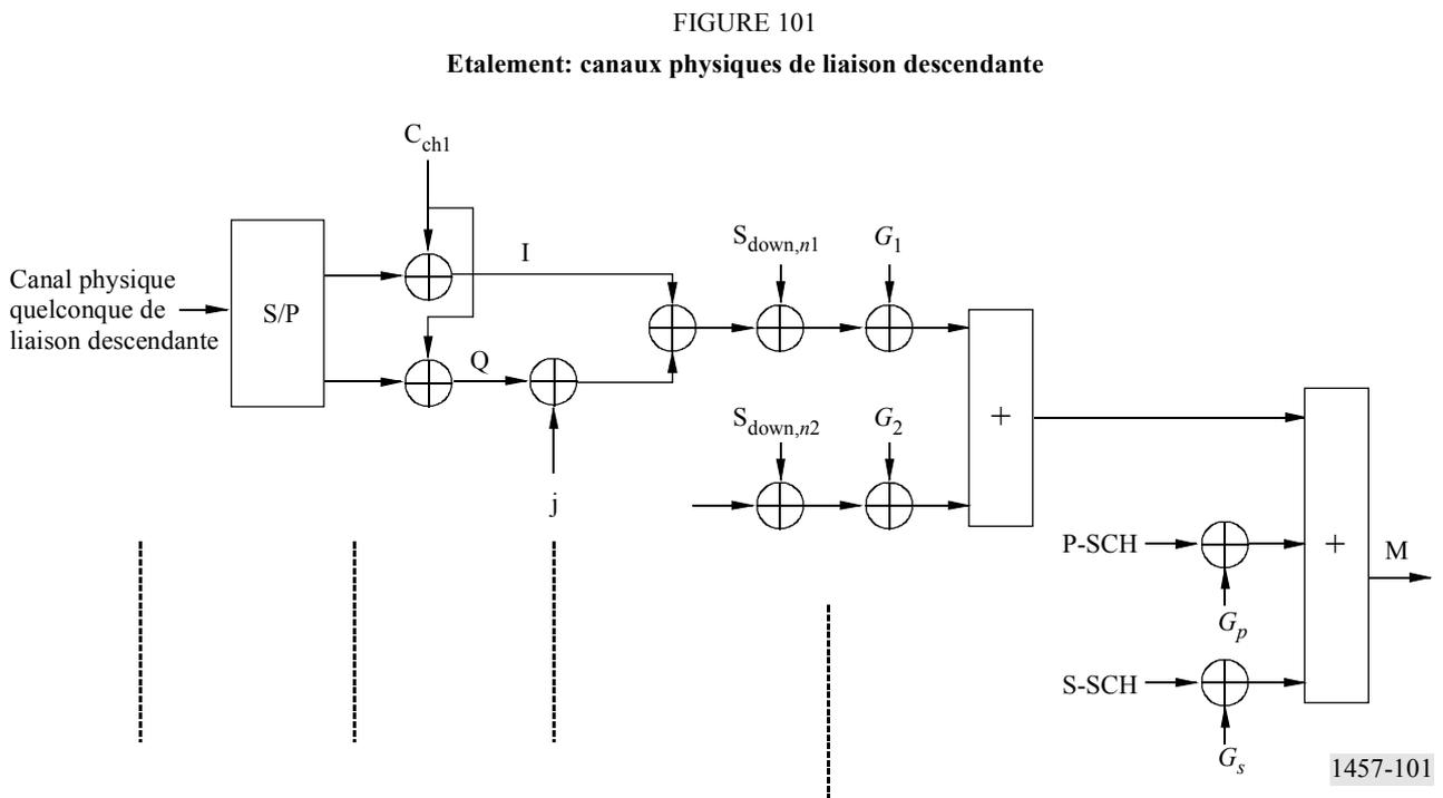
Les codes de découpage pour les canaux physiques de la liaison descendante sont les codes OVFSF utilisés sur la liaison montante.
