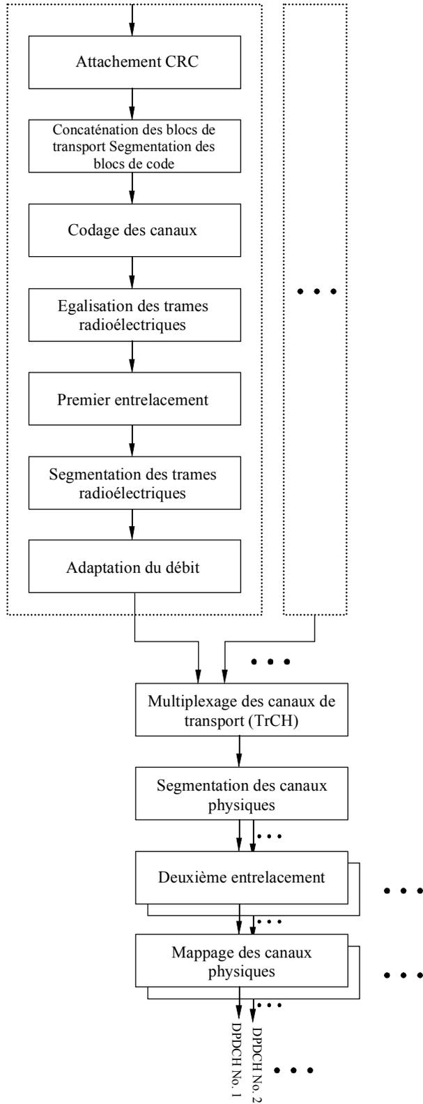
Les types de codage de canaux définis sont le codage convolutif, le codage turbo et l'absence de codage. Les services en temps réel utilisent uniquement le codage CED tandis que les services qui ne sont pas en temps réel utilisent une combinaison de CED et d'ARQ (demande de retransmission automatique). Cette dernière fonction réside dans la couche RLC de la couche 2. Le taux du codage convolutif est soit de 1/2, soit de 1/3 alors qu'il est de 1/3 pour les codes turbo.
