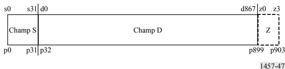
Chaque paquet physique contient un champ de synchronisation S et un champ de données D. Les paquets P80, P32 et P08 peuvent contenir un champ optionnel Z de détection des collisions.
