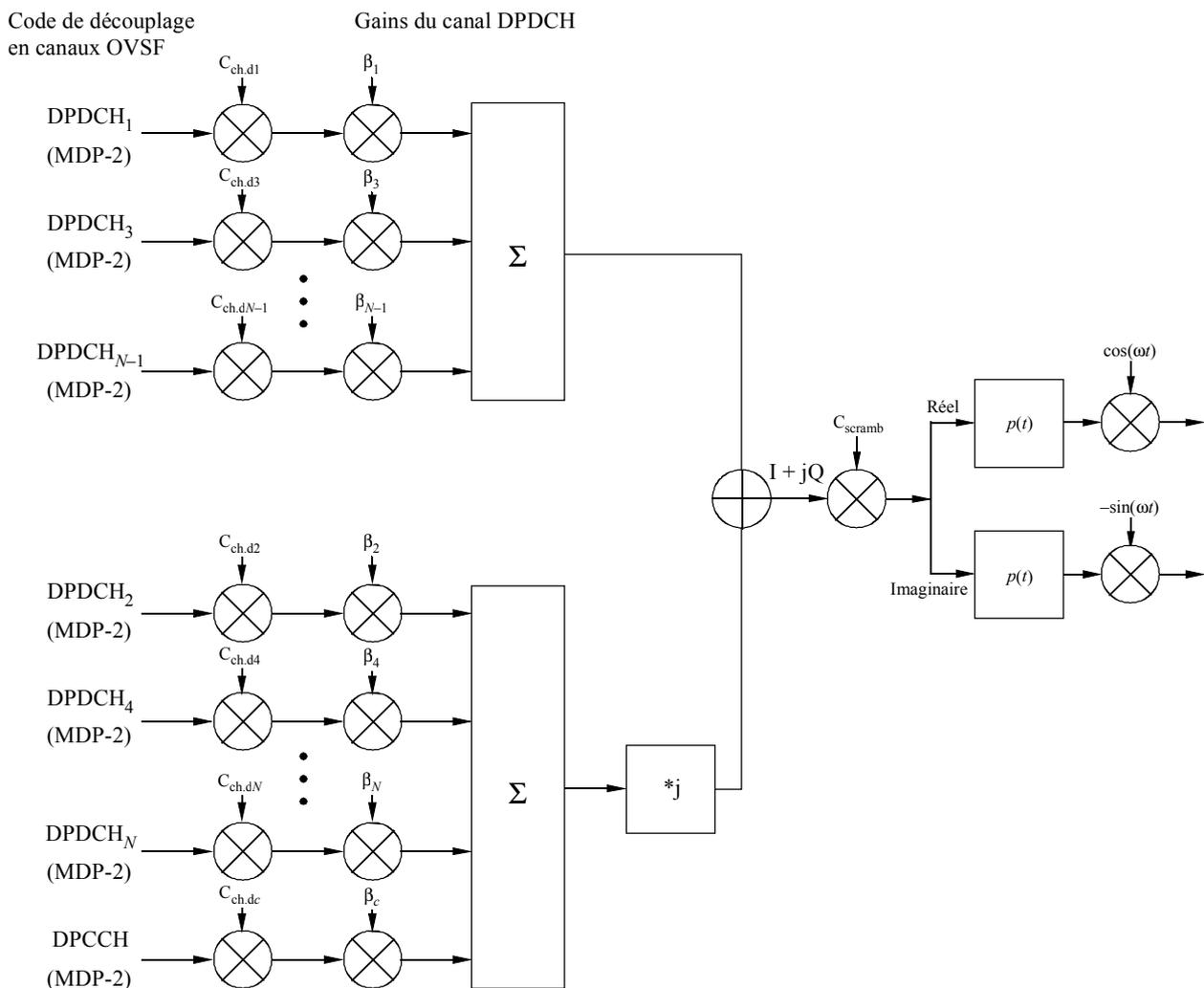
Les filtres de modelage des impulsions sont du type en racine de cosinus (RRC, *root-raised cosine*) avec une décroissance  $\alpha = 0,22$  dans le domaine fréquentiel.
