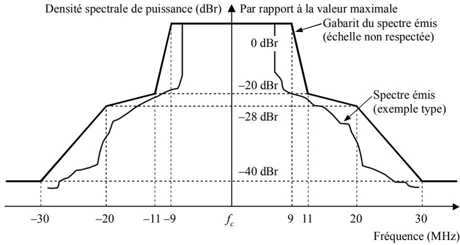
*Note 1* – Le trait extérieur plein correspond au gabarit spectral pour les systèmes 802.11a, 11g, 11j, HIPERLAN2 et HiSWANa, et le trait fin à l'intérieur représente l'enveloppe spectrale des signaux MROF avec 52 sous-porteuses.
