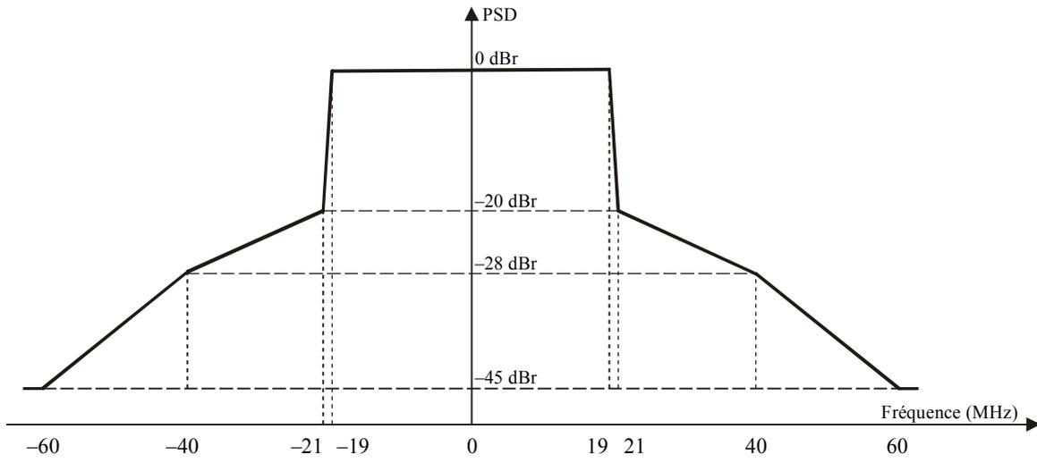
*Note 1* – Maximum de -45 dBm et -56 dBm/MHz à un décalage de fréquence égal ou supérieur à 60 MHz.
