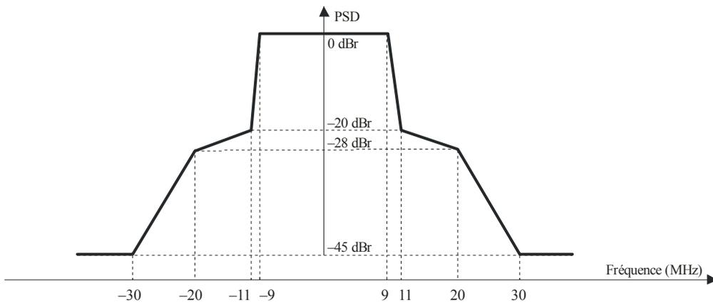
*Note 1* – Maximum de -45 dBr et -53 dBm/MHz à un décalage de fréquence égal ou supérieur à 30 MHz.
