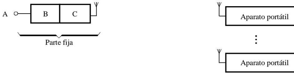
a) Diagrama de bloques de un sistema telefónico sin cordón de múltiples terminales
