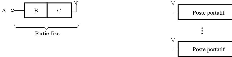
a) Schéma synoptique d'un téléphone sans cordon à terminaux multiples
