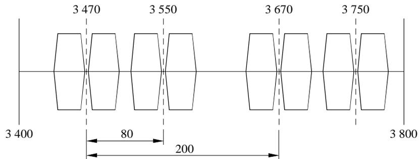
c) Disposition des canaux dans la bande 3 400-3 800 MHz avec utilisation d'un système à deux porteuses transmettant à  $8 \times 155,52$  Mbit/s (STM-1) en mode CCDP. Utilisé en Suisse
