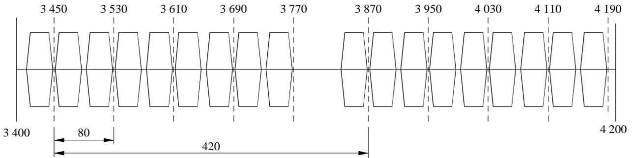
b) Disposition possible des canaux dans la bande 3 400-4 200 MHz avec utilisation d'un système à deux porteuses transmettant à  $(16 + 2) \times 155,52$  Mbit/s (STM-1) en mode CCDP
