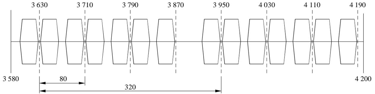
a) Disposition des canaux dans la bande 3 580-4 200 MHz avec utilisation d'un système à deux porteuses transmettant à  $(12 + 2) \times 155,52$  Mbit/s (STM-1) en mode CCDP. Disponible en Allemagne
