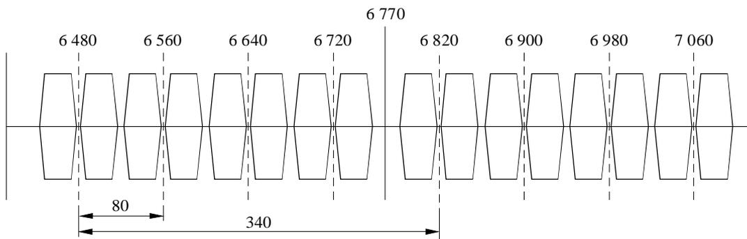
b) Disposition préférée des canaux si la compatibilité avec des faisceaux hertziens analogiques n'est pas requise
