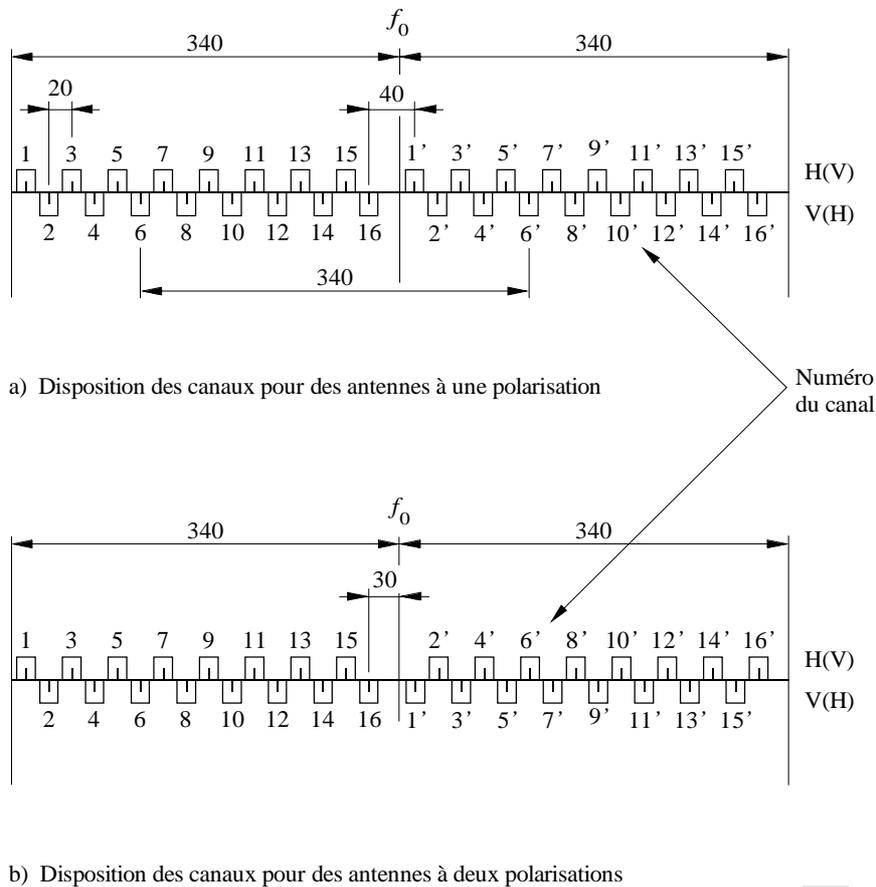
**11** que, dans le cas d'une transmission multiporteuses (Note 5), l'ensemble des  $n$  porteuses soit considéré comme un seul canal. La fréquence centrale de ce canal est définie conformément au § 1 ou au § 7, quelle que soit la fréquence centrale réelle des porteuses, qui peut varier pour des raisons techniques, en fonction de leur réalisation pratique. Le fonctionnement des systèmes multiporteuses est traité plus en détail dans l'Annexe 1.
