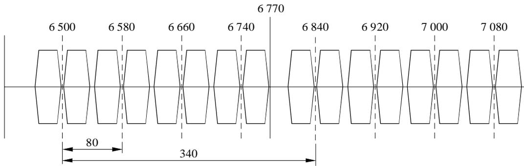
a) Disposition préférée des canaux si la compatibilité avec des faisceaux hertziens analogiques est requise
