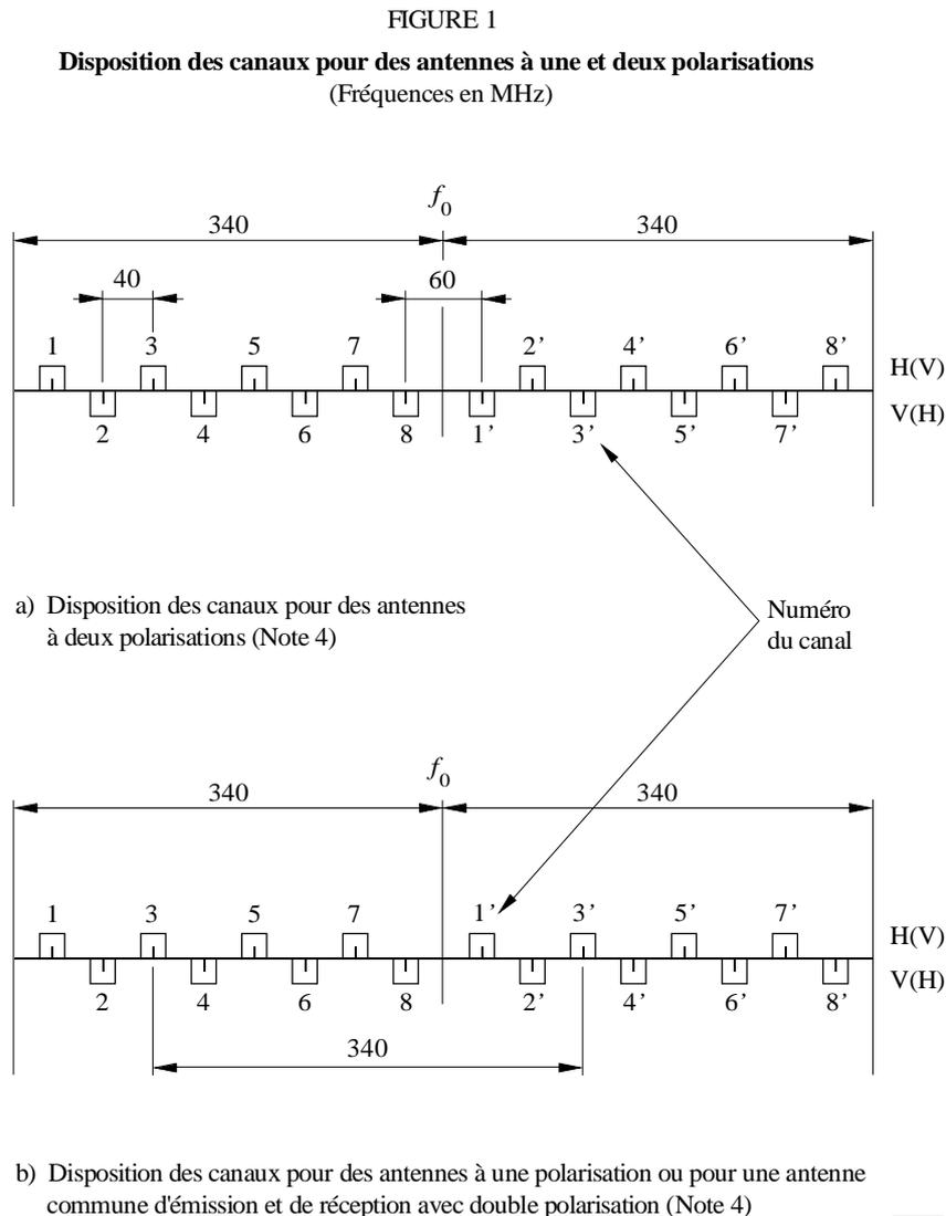
7 que la disposition préférée des canaux radioélectriques pour un maximum de 16 canaux aller et 16 canaux retour, ayant chacun une capacité maximale de 1 260 voies téléphoniques ou leur équivalent, ou des débits numériques de valeur moyenne en fonctionnement plésiochrone ou synchrone, soit obtenue en intercalant des canaux additionnels entre ceux de la disposition principale et soit exprimée par les relations suivantes:
